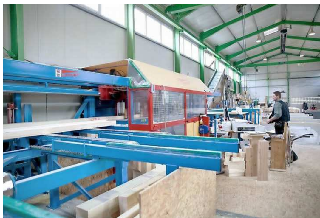
Computergesteuert wird das Bauholz passgenau zugeschnitten.
